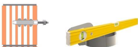
Abb. 3 Beispiel, Injektionsankerbefestigung bei Mauerwerk
