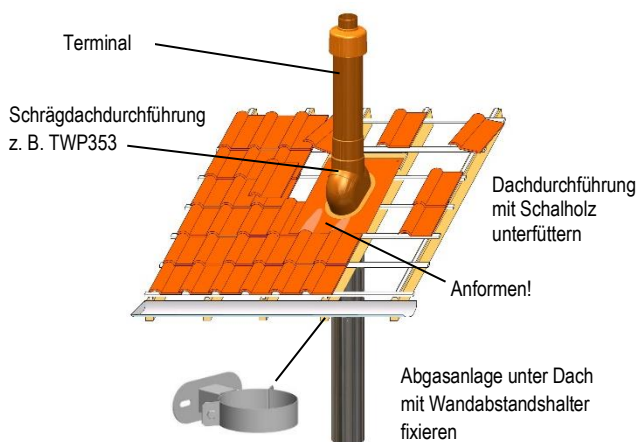
Abb. 8 Schrägdach mit typischer Dachhochführung
