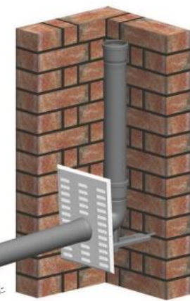
Abb. 1 Dehnungsaufnahme langer Leitungsabschnitte durch Langmuffen
